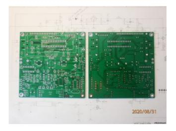
Есть у меня и модули на Si5351, однако, для улучшения дизайна монтажа печатной платы, решил собрать отдельный синтезатор на предусмотренном для этого месте на плате, используя для микросхемы Si5351 переходную плату DIP10 - 10MSOP, отдельную микросхему стабилизатора 3.3 В, а также, кварц на 25 мГц. Благо, у меня всё это есть в наличии. Получится намного симпатичней, чем вешать на плату отдельный модуль.
