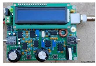
Модернизированный микротрансивер, получивший название **uSDX**, помимо дополнительно расширенного частотного диапазона (до 50 мГц) имеет возможность работать и в SSB режиме. Вот он на фото (v.1.0.3):
