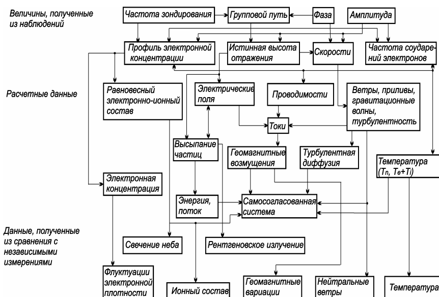
Рис. 7. Геофизические функции современного ионозонда.
